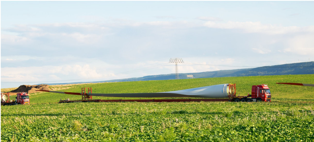
FOTOGRAFÍA 5. Ejemplo de transporte de las aspas de un aerogenerador hacia el emplazamiento de un proyecto
