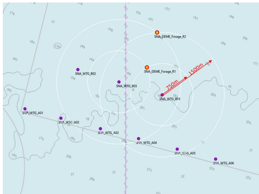
FIGURE 11 : PLAN D'INSTALLATION DES ENREGISTREURS ACOUSTIQUES (R1 ET R2) AUTOUR DES FONDATIONS B03 ET B04
