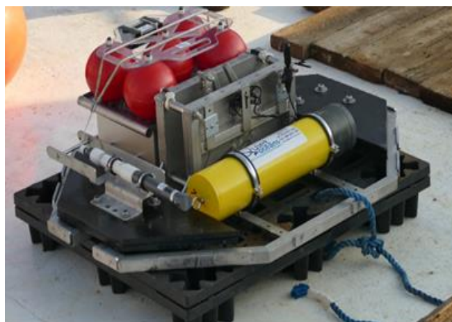
Figure 16 - Cage équipée d'un enregistreur acoustique autonome (source : Quiet-Oceans, 2020)
